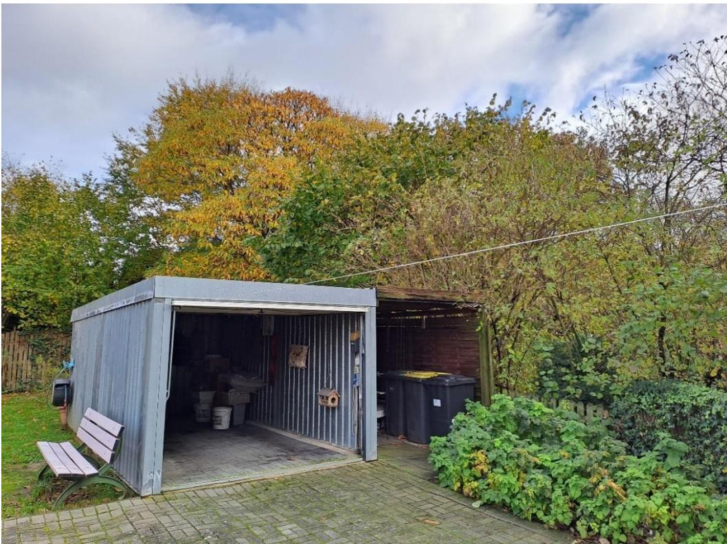
*Abbildung 5: Blick auf die Garage aus Trapezblech mit einem angebauten, überdachten Mülltonnen-Stellplatz als Holzkonstruktion, welcher bereits außerhalb des Plangebietes liegt (eigene Aufnahme 15.11.2023)*
