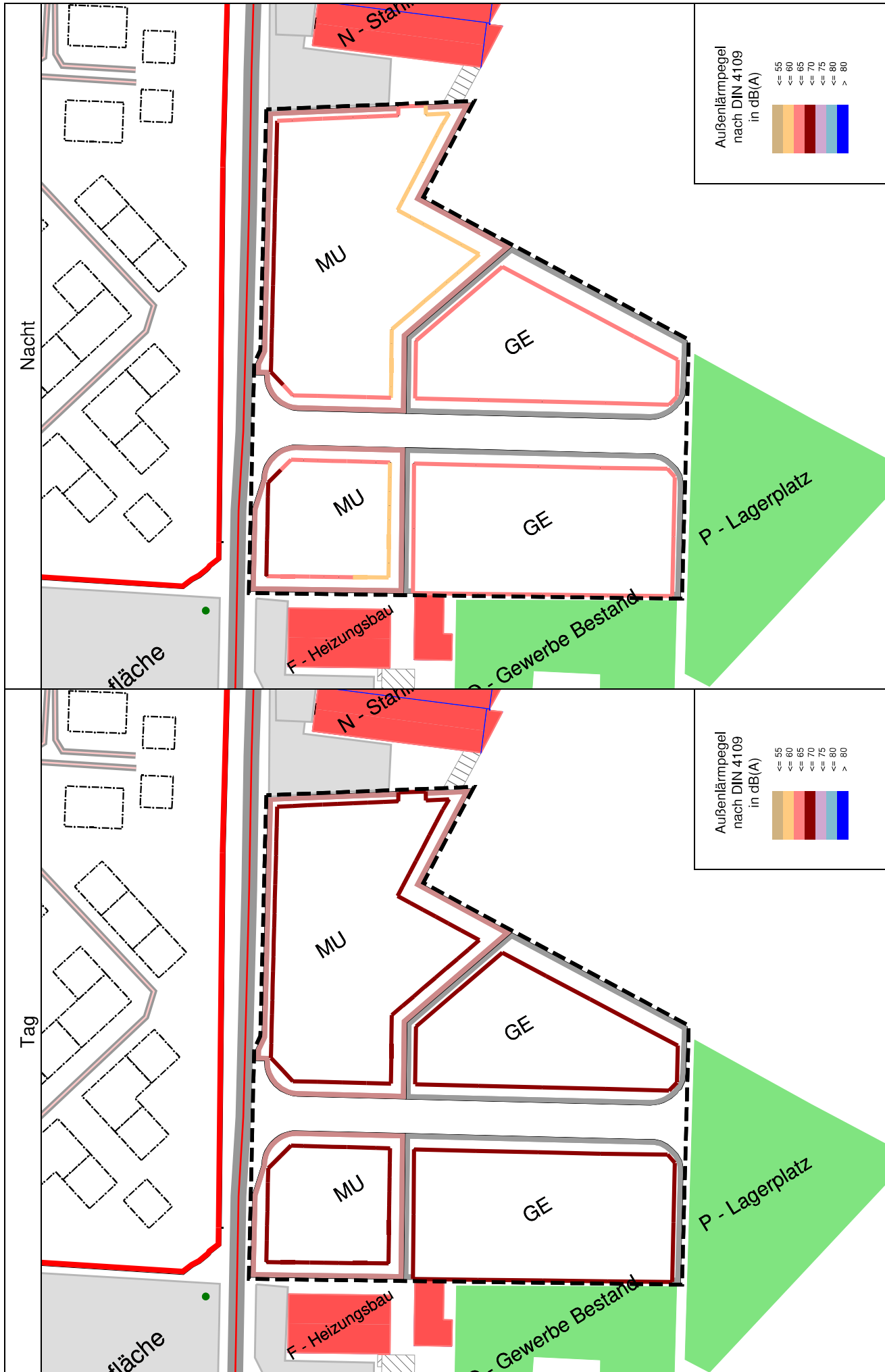
Anlage 9: Lageplan mit Kennzeichnung der Außenlärmpegel nach DIN 4109 (Tag/Nacht)
