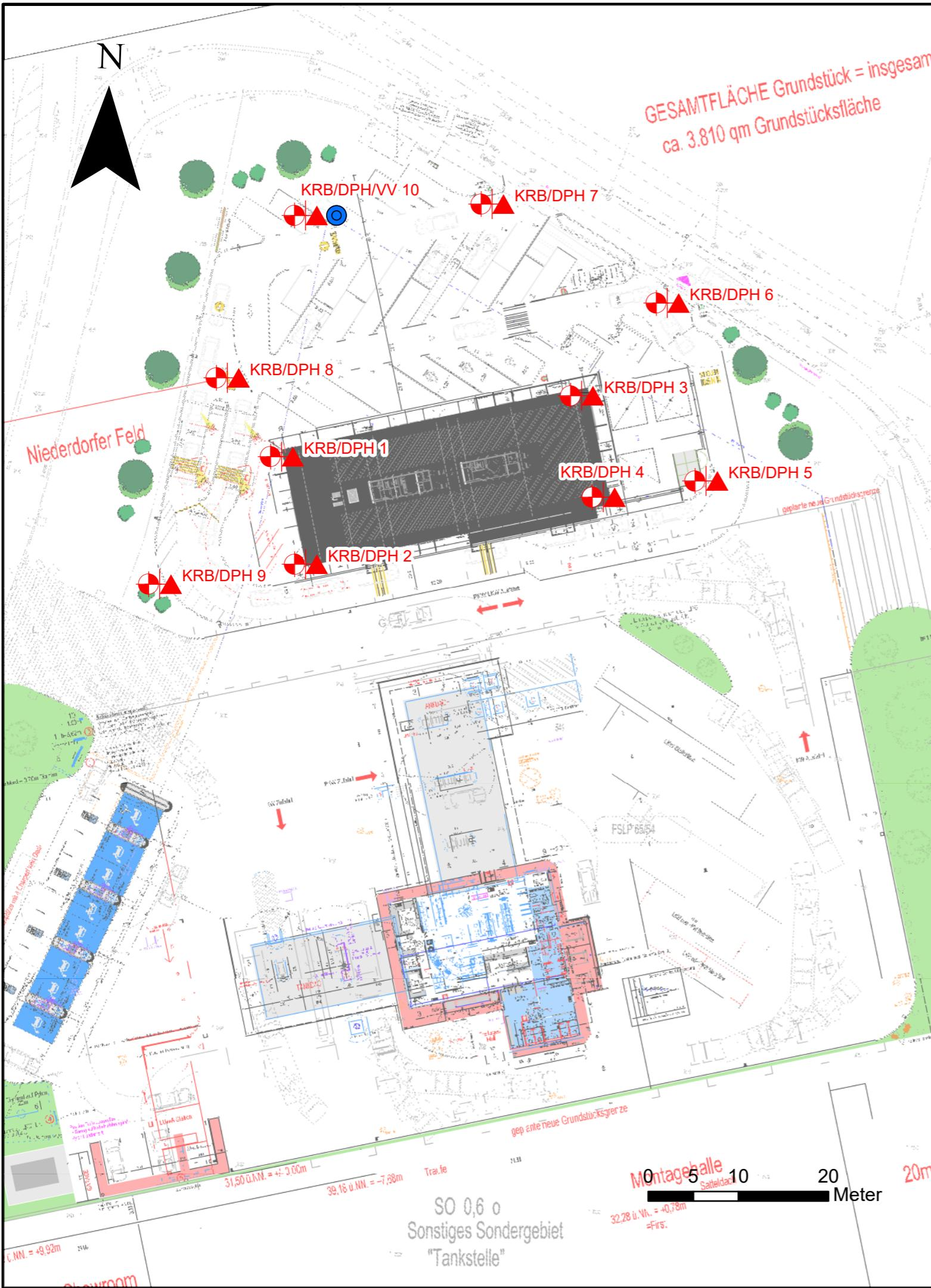
◆ Kleinrammbohrung/schwere Rammsondierung (KRB/DPH)
